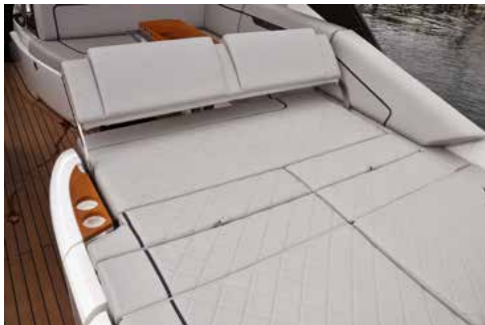
Klappt man die Rückenlehne der Sitzbank um, entsteht eine große Liegefläche. Bild: hdm
