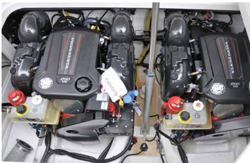
Motorraum mit hydraulischer Klappe und viel Platz für die Doppelmotorisierung Bild: hdm
