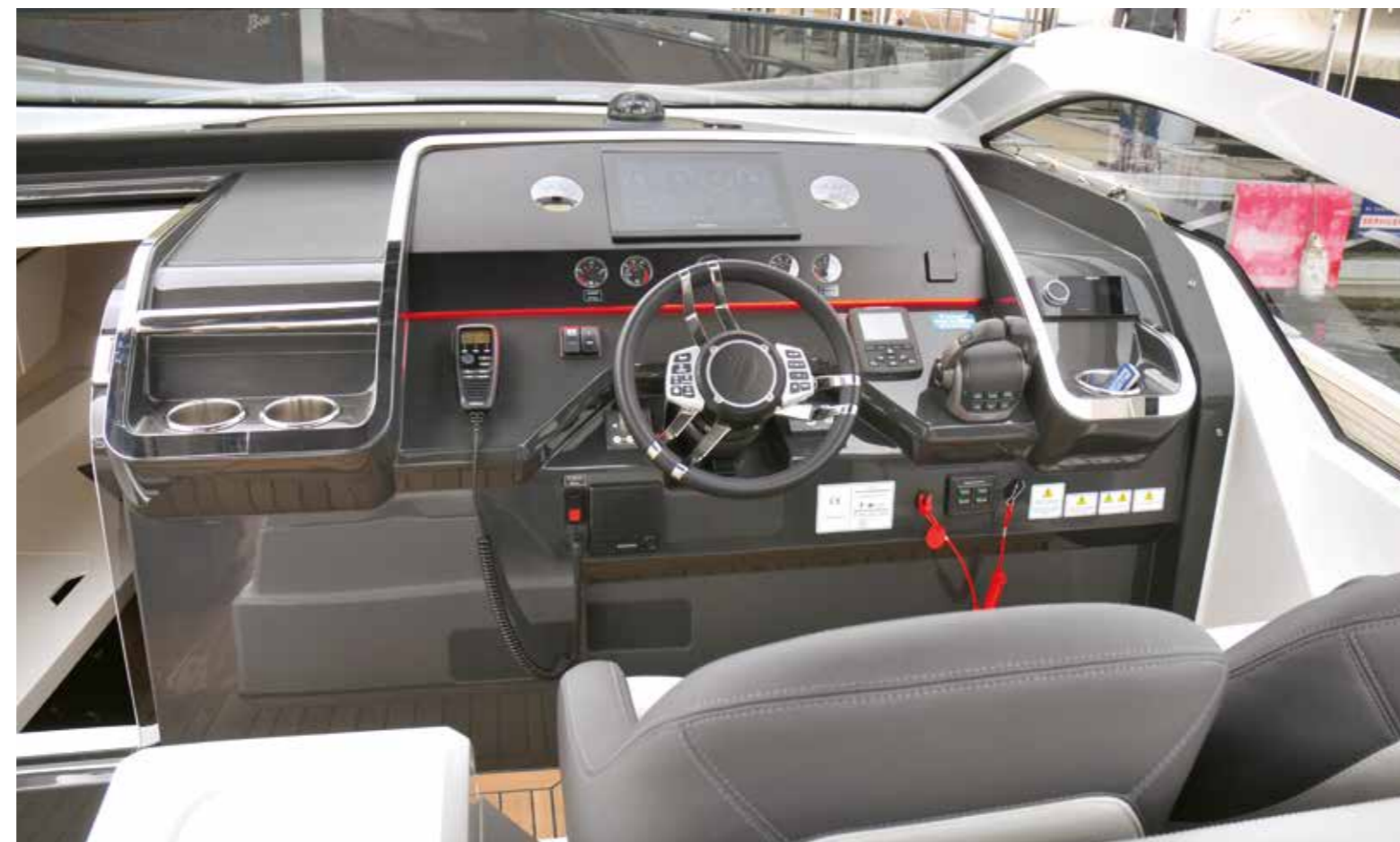
Aufgeräumt wirkt der Steuerstand. Der Plotter ist sehr flach eingebaut und nicht immer gut ablesbar.
