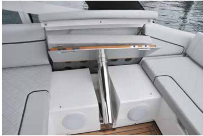
Der Tisch hat einen massiven Standfuß. Er wird abgeklappt und hinter den Polstern verstaut. Bild: hdm
